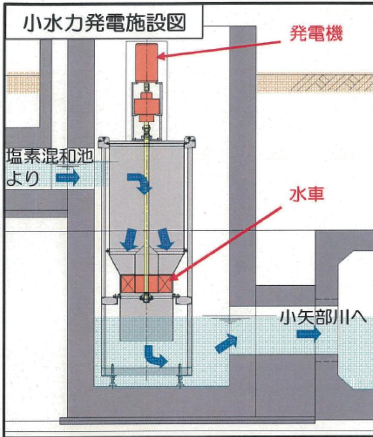
図7. 小矢部川流域下水道二上浄化センターのマイクロ水力発電<sup>23)</sup>
