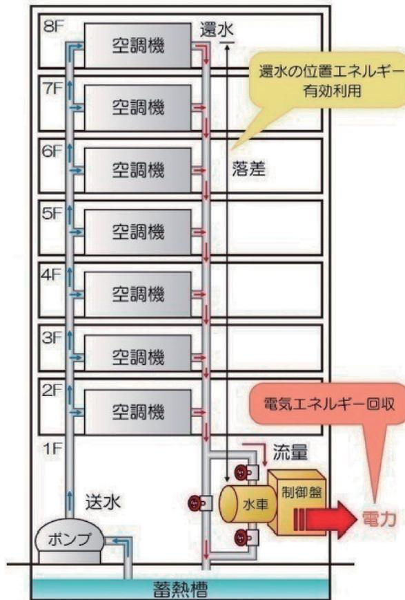
図8. NHK放送センターのマイクロ水力発電システム概念図<sup>24)</sup>
