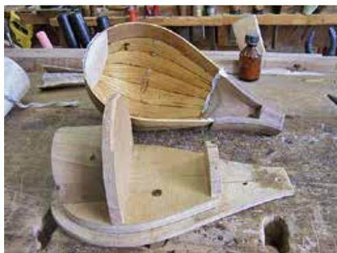
図3-16：接着固定の翌日に脱型した共鳴胴と型。仮釘はこの段階で外す。
