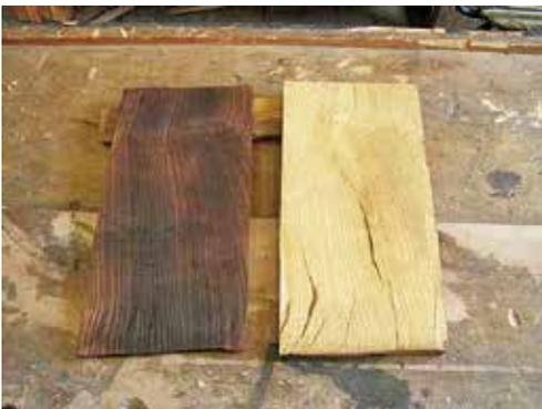
図3-51：甲板の製材と燻し加工。ここではオープンで蒸し焼き炭化させ着色する手法をとった。
