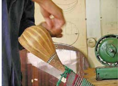
図3-60：表面はサンドペーパー仕上げの後、水拭きで余分な木の導管を起こし、キサゲでこそぎ滑らかにする。
