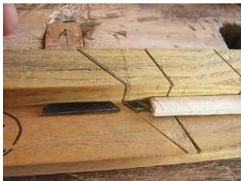
図3-30：骨、角ともに装飾材料は切断用具にあわせて切り出す。
