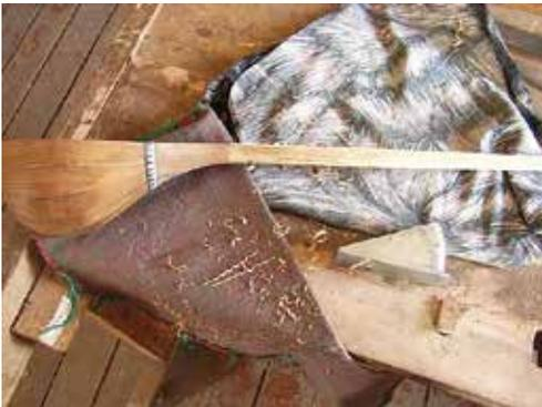
図3-47：固定後、ボグスと棹の造形作業を行う。鉋やヤスリを使用して慎重に進める。
