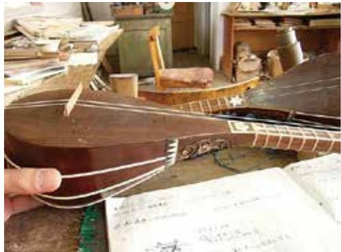
図3-70：ハーレッキ（駒）の高さ設定をして、適正な寸法で駒を製作する。
