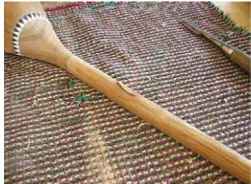
図3-48：作業を進める途中で生じた割れや欠損は、埋木で処理する。
