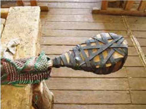
図3-55：膠で貼付けた後、帯ゴムを巻いて固定。甲板の盛り上がり部分を押しえないよう巻付け方を工夫する。
