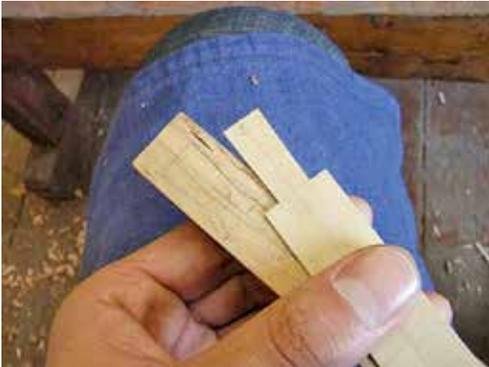
図3-33：ひな型を使用した棹とボグスの木組みの墨付け。
