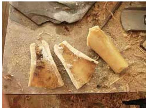
図3-24：骨装飾材の平面が多く確保できるように製材する。内側に肉質が残っていることがあれば除去する。
