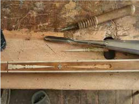
図3-39：装飾加工を施した骨を指定の位置に象嵌。彫り込みの深さは1ミリ。削り代を残して埋め込む。
