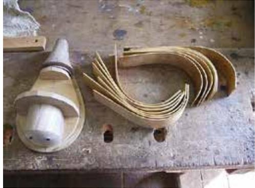
図3-10：左右別に曲げ上がった共鳴胴用板材。曲げた材は型に沿わせ、必要寸法に合わせて適宜調整する。
