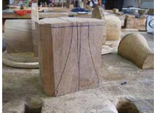
図3-4：底を第一基準面に、垂直に第二基準面を設定し、ひな形を用いて墨付けする。
