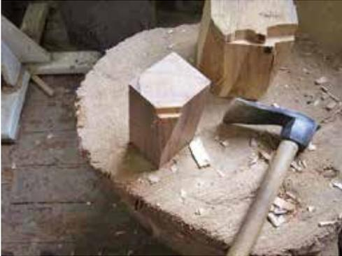
図3-3：ボグスの製作はヨンゴーク（胡桃材）から削り出す。ボグスは構造材なので堅い材であることが必須。
