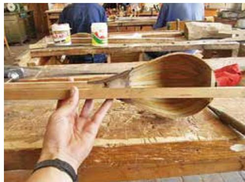
図3-36：仮組み作業。棹の先端～木組み部分～弦掛けまで、棹の中心軸がねじれていないか木尺で確認する。
