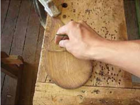
図3-53：甲板の内側を凹面になるようにガラスで削ぐ。
