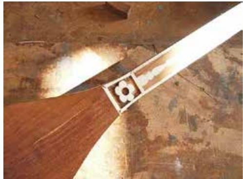
図3-58：彫り下げた部分に骨装飾材で棹を貼付ける。花はまだ貼付けない。
