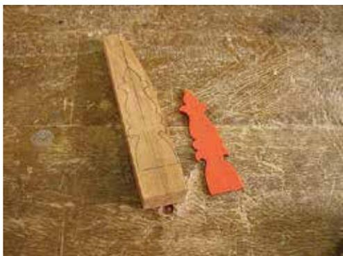
図3-19：コトレッキ（弦掛け）は5ミリ厚のウーリック（杏子材）で製作。右はプラスチックひな形。
