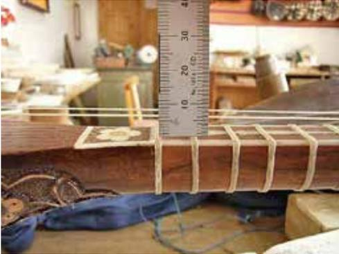
図3-71：一番共鳴胴側のパルダールから、弦の高さを6ミリに設定。実際は使いながら適宜手を加え調整する。
