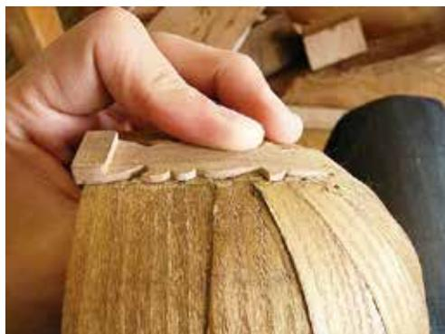
図3-20：弦掛け成型後、深さを1.5ミリ彫り下げ、共鳴胴に嵌め込む。
