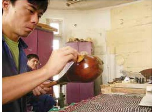
図3-62：共鳴胴のみ、シェラックのアルコール溶液をタンポで塗布乾燥させる。数回繰り返し塗り塗面を整える。
