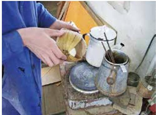
図3-14：接着直後に熱で焙り、接着部分の膠を沸騰させる。これにより接着力が高まる。
