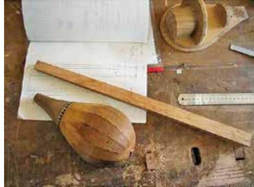
図3-32：装飾が施された共鳴胴に引き続き、棹の製作を行なう。使用木材はウーリック（杏子材）。
