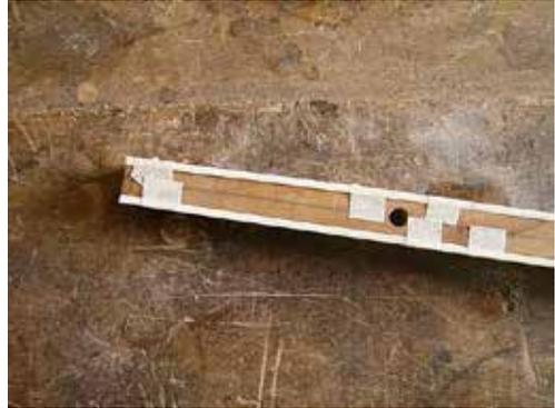
図3-38：棹両脇の溝を幅2ミリ深さ1ミリに彫込み、骨装飾材を貼付ける。
