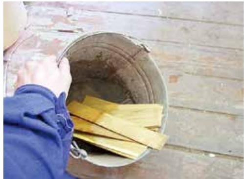
図3-8：共鳴胴用板材は加工直前にさっと水にくぐらせ湿らせる。水に浸しすぎると板が暴れるので注意する。
