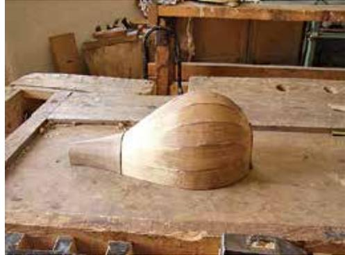
図3-22：装飾準備のためボグス接続側もこの段階で滑らかにする。ボグスと共鳴胴の段差をとる作業は後で行う。
