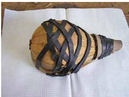
図3-15：最終段の接着固定は帯ゴムの巻きで対処する。ボグスと板材は仮釘で固定する。
