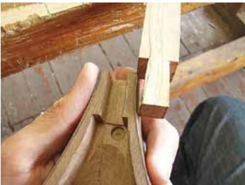
図3-35：棹側を基準にボグス側の溝をすこしずつ彫り込み、嵌め込みを調整する。
