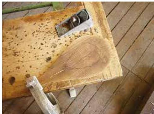
図3-52：厚さは5ミリ、共鳴胴の寸法から5ミリ大きめに合わせ切り抜く。甲板の外側は凸状に成型する。
