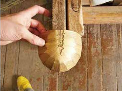
図3-21：弦掛け接着前に周辺の段差をなくす。仮釘痕は共鳴胴と同じトウト（桑材）で作った木釘で埋め込む。
