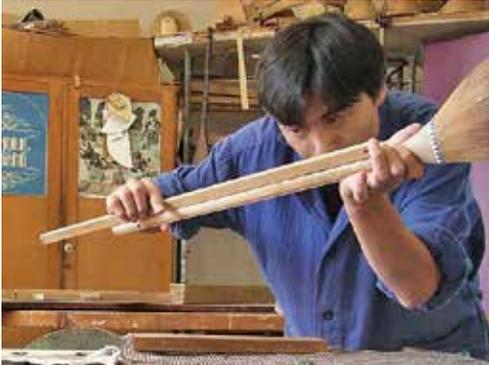
図3-49：棹は木尺を当て隙間がないことを確認。隙間があるとパルダナー紐（フレット）の固定が難しくなる。
