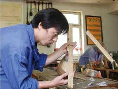
図3-45：棹と共鳴胴の接着を行なう。中心軸がずれていないか、角度は適正かを確認する。
