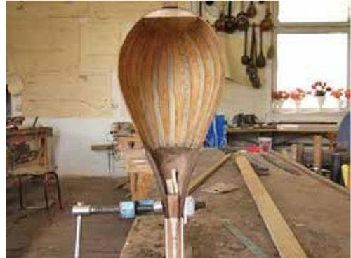
図3-46：膠が固まるまでしっかり固定する。微調整は木片を差し込んで行う。
