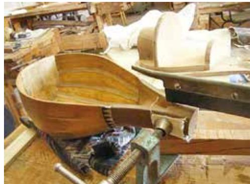
図3-34：同じひな型を用いた墨付けに鋸を入れる。
