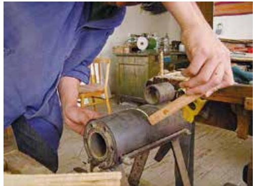
図3-64：製材後、直ちに共鳴胴の曲面に合わせて曲げ加工を行う。
