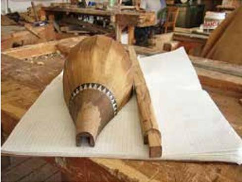
図3-37：仮組みしながら棹とボグスの接続面を円弧状に成型した後、装飾作業に入る。
