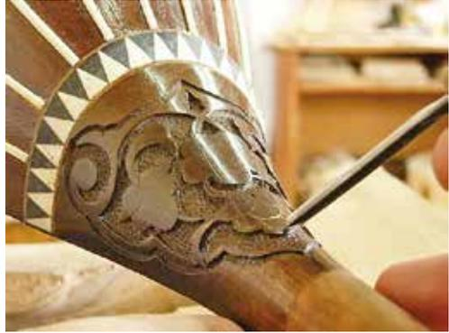
図3-66：ボグスの浮彫り裝飾の仕上げ作業。
