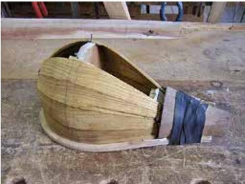
図3-13：四段目の接着完了。楔で面を密着させ固定の補助とする。
