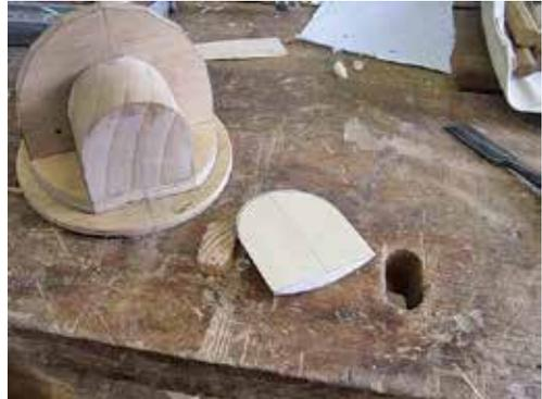
図3-6：柔らかく成型しやすいので、寄木を尾底部に接着するにはサスナ（松の一種）を使用する。
