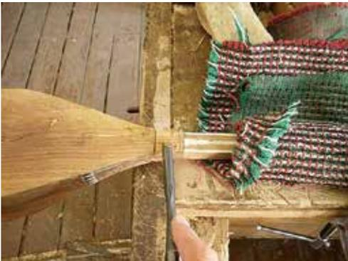
図3-57：棹接続部分の象嵌装飾。施行部分の甲板は1ミリ彫り下げる。
