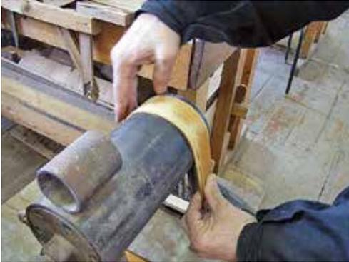
図3-9：十分熱が通ったペチカに木を当て、曲げ加工を行う。板材はトゥット（桑材）を使用する。
