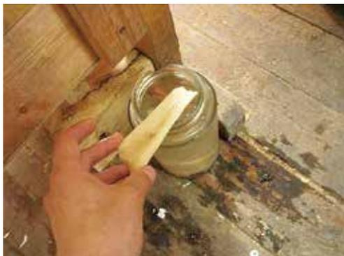
図3-25：加工に際し、骨材を水に漬け込むと多少柔らかくなる。水の交換は頻繁に行なうよう心がける。
