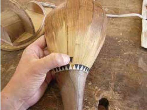
図3-31：装飾材を貼り付ける。接着には木工用ボンドを使用した。
