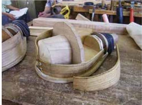
図3-12：一段目の成型以降も同様の作業で進める。二段目からは傾斜がついてくるので何度も確認し進める。
