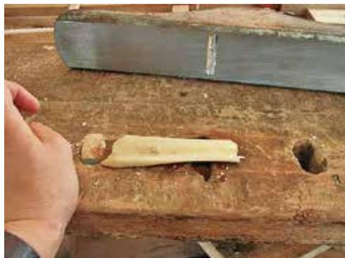
図3-26：鉋で製材する。水分を切らさないように進める。
