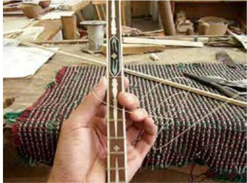
図3-68：バルダー（フレット）は、ガット弦を結んで作る。設定場所より細い所で結び、移動させるとよい。
