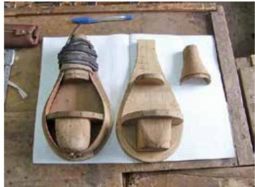
図3-2：左は板材貼り工程作例。中は型。右は棹と胴を接続する部位（ボグス）。
