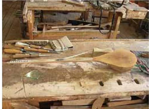
図3-56：固定後、甲板の上から下に鑿をかけ余りを削り落とす。逆に動かすと剥がすおそれがあるので注意。
