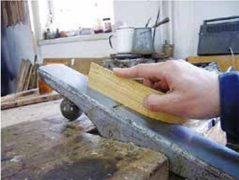
図3-11：鉤を作業台に固定し、共鳴胴板の面を平面にする。
