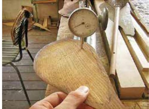
図3-54：マイクロメーターを使い厚みを計測する。2.5ミリが目安である。
