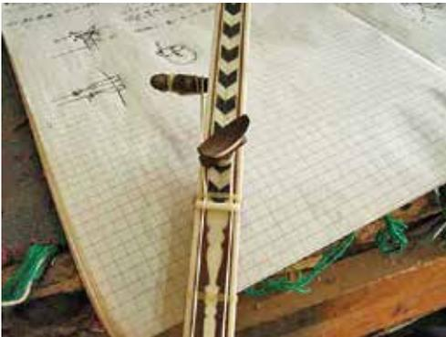
図3-69：下弦掛けから上弦掛けを経るように絹糸を張り、コラーク（ペグ）に巻き取り棹に留める。
