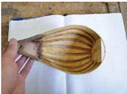
図3-17：板接着部分の補強のため内側から布を膠で貼る。乾燥させて補強作業は完了。
