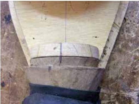
図3-7：帯ゴムを巻いてボグスを型に固定。板材接着部の精密加工を行い、共鳴胴板材貼付けに備える。
